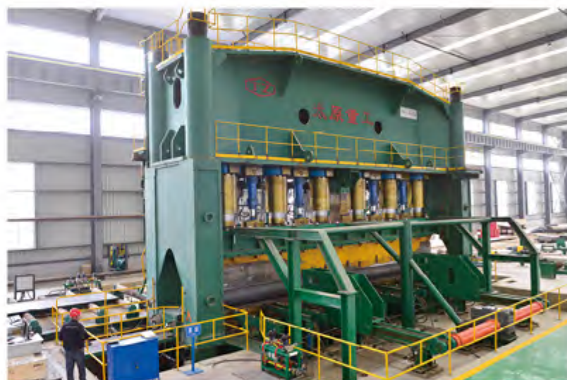
直缝焊管机组
