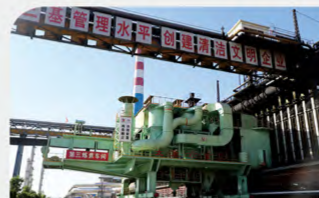
推焦车车载式除尘系统
