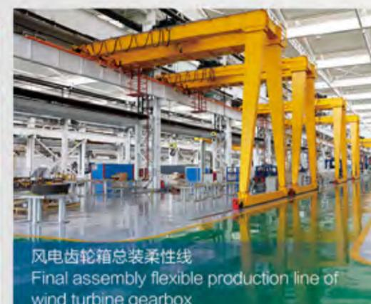
风电齿轮箱总装柔性线
