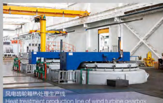
风电齿轮箱热处理生产线
