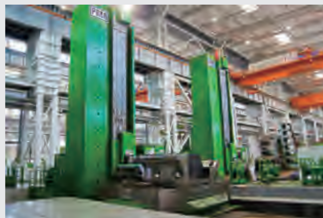
意大利帕马的φ260毫米双立柱落地镗铣床 Italy PAMA φ260mm CNC floor type milling machine
